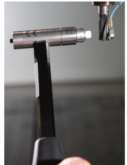
"Tap-test" af fræsere – en del af vibrationsanalysen.
