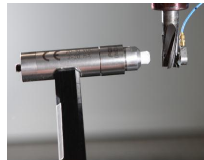
"Tap-test" af fræser – en del af vibrationsanalysen.
