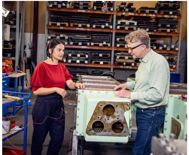
Milena Watanabe Bavaresco, phd. studerende fra Brasilien med speciale i vibrationer står sammen med Frank Nielsen fra Vestas Aircoil i gang med at montere et accelerometer for at bestemme kølerens egenfrekvens. Frank Nielsen var en del af det oprindelige testhold, der arbejdede sammen med DAMRC.
